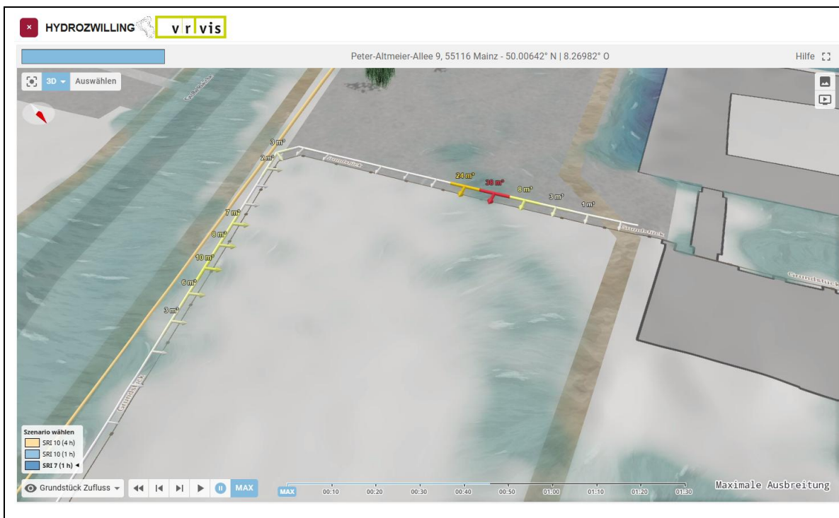
Grundstückszufluss: Zeigt, an welchen Stellen der Grundstücksgrenze wieviel Wasser in m^3 auf das Grundstück übertritt. Diese Darstellung funktioniert nur bei unbebauten Grundstücksgrenzen.
